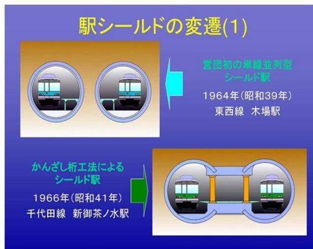
営団初の単線並列型シールド駅は、東西線木場駅です。木場駅は始端部と終端部に立坑があり、その立坑を2本のシールドトンネルが結んでおり、シールド部分では上下線ホームが行き来できない構造になっています。これではお客様にとって不便なので、千代田線新御茶ノ水駅では2本のシールドトンネルの間に「かんざし桁工法」により切り抜けて、島式ホームとしたで築造しました。
